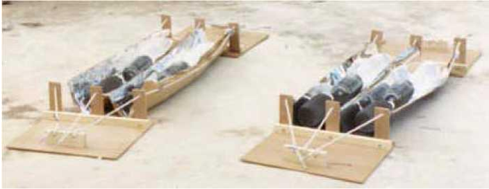
Рис. 11.2 Сонячні рефлектори. Ліворуч: алюмінієва фольга. Праворуч алюмінієвий лавсан.
